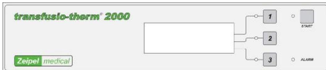
**Figure 3.1 :** Afficheur, divers voyants lumineux et les touches de commande
